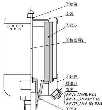
含在排出空气中的油烟，在滤芯的表面和内部，靠惯性冲击，布朗运动扩散等而捕捉。
