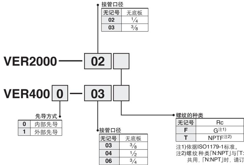
注)在订隔板型减压阀(B通口减压阀)、节流阀隔板、带压力表的场合，电气比例阀的型号与要加\*的可选项型号并记。可选项型号参见P.893可选项表。出厂时，呈非组件状态，为同一包装。
